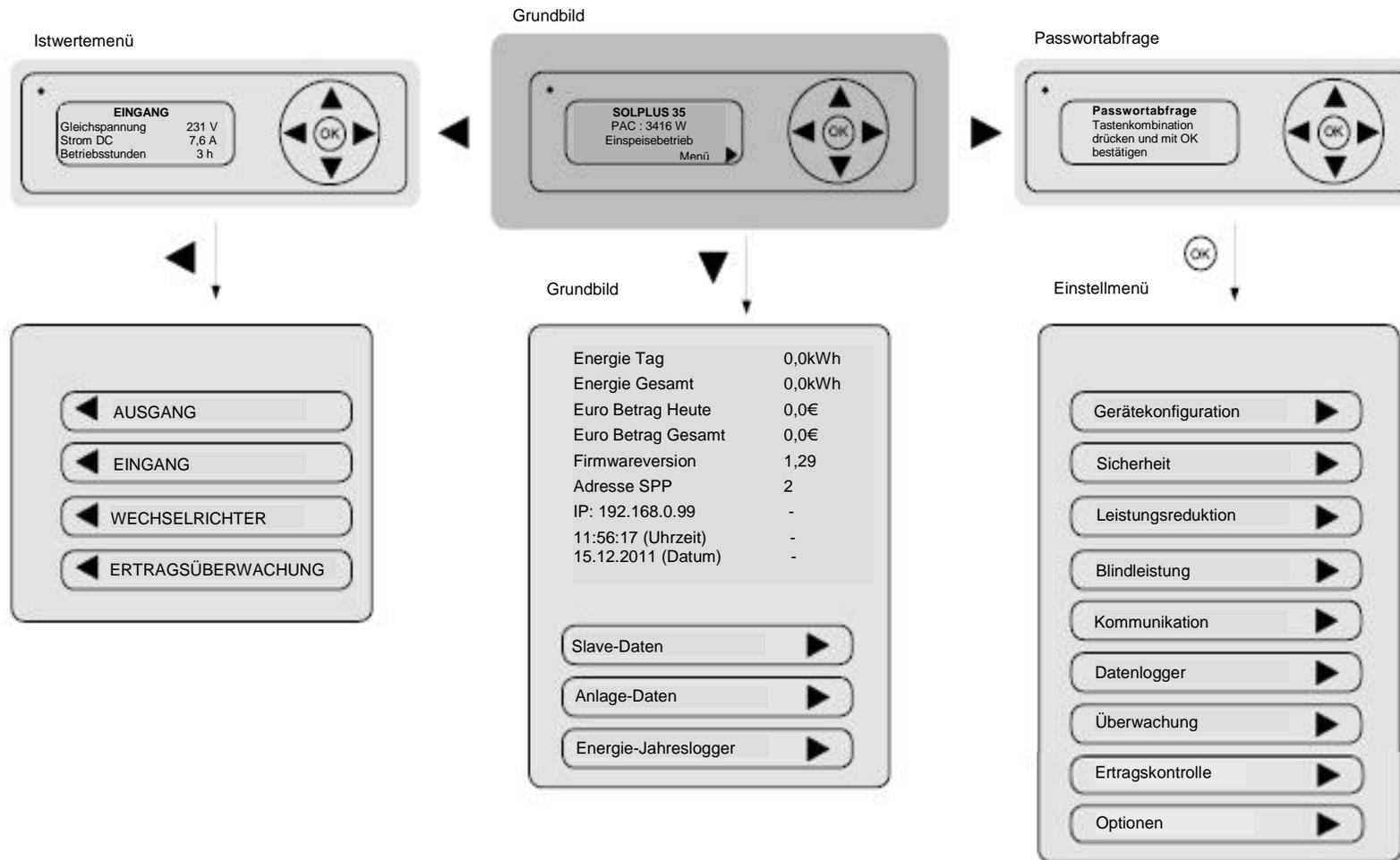
**Das Istwertemenü:** wird erreicht, indem die Pfeiltaste auf dem Display nach links gedrückt wird. Das Istwertemenü ist in vier Menügruppen unterteilt, in denen verschiedene Parameter abgelesen werden können. Durch nochmaliges Drücken der Pfeiltaste nach links gelangt man in das nächste Menü. Am Ende kommt man wieder ins Grundbild.
